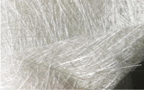
Hilos cortados de fibra de vidrio que se mantienen cohesionados gracias a un emulsionante. Aconsejado para impermeabilizaciones, construcción de laminados estructurales (automoción, industria, piscinas,...) y moldes con resinas de poliéster.
