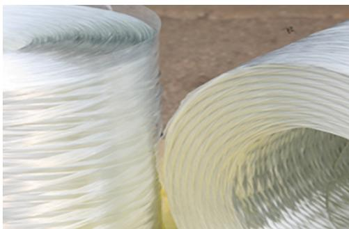
Roving ERS240 T132BS es para aplicaciones de pulverización de uso general, tamaño de silano, excelente compatibilidad con insaturados poliéster y resina de vinilo. Aplicar a partes de camiones, baños, yates.
